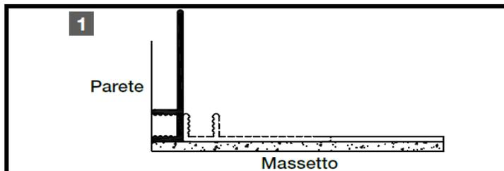
Utilizzare lo spessore della base in PVC per calcolare la distanza dalla parete dove fissare la base stessa.
