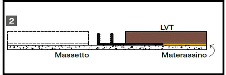
Posare il pavimento lasciando lo spazio di dilatazione necessario ed eliminando l'eventuale parte di materassino sopra la base in PVC.
