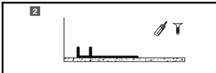
Assicurarsi che la superficie sia pulita e regolare e fissare la base in PVC con collante o viti in tutta la sua lunghezza.
