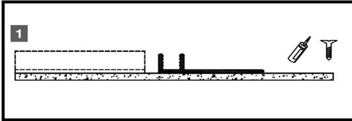
Assicurarsi che la superficie sia pulita e regolare e fissare la base in PVC con collante o viti in tutta la sua lunghezza.
