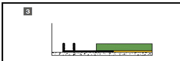
Posare il pavimento lasciando lo spazio di dilatazione necessario ed eliminando l'eventuale parte di materassino sopra la base in PVC.
